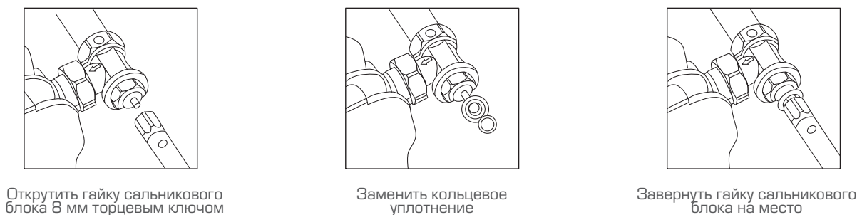
Рис. 21. Замена кольцевого уплотнения штока клапана терморегулятора
